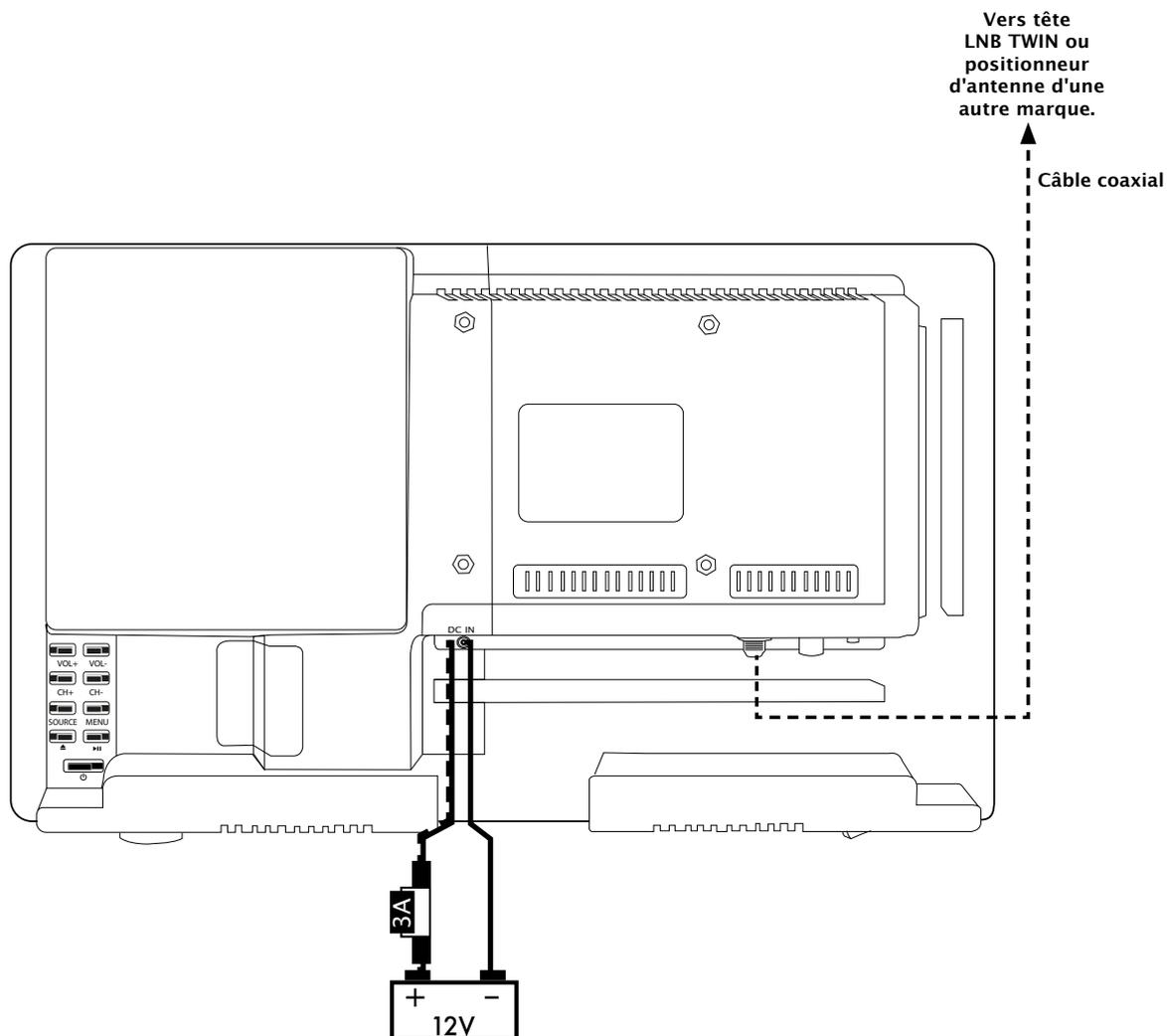
**ATTENTION:** Le schéma d'installation ci-dessus s'applique dans le cas où le TV AIO SATMATIC-HD est connecté à la seconde sortie coaxiale d'une antenne équipée d'un LNB TWIN ou s'il est connecté à un module de pointage de satellite d'une autre marque.
