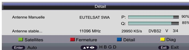
4. Référéz-vous aux instructions de votre antenne pour la positionner. Le téléviseur AIO SATMATIC-HD émet un bip sonore continu lorsque le satellite est verrouillé. Ajuster alors la position de votre antenne afin d'obtenir le meilleur niveau de puissance (P) et de qualité (Q) possible. Appuyez sur la touche EXIT de la télécommande pour stopper le bip sonore continu émis par l'AIO SATMATIC-HD.
